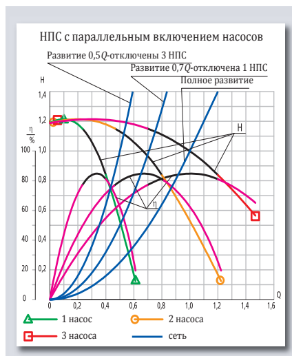
Рис. 3. Характеристики сети и НПС при параллельном включении насосов
