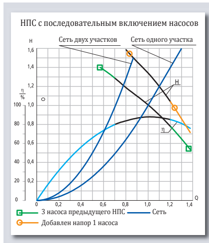
Рис. 5. Характеристики сети со статической составляющей и НПС при последовательном включении насосов
